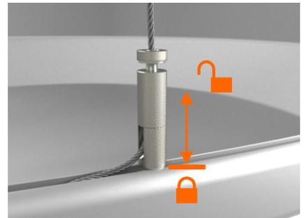
Um den Halter nach unten zu verschieben muss dieser zunächst entlastet werden. Die Sicherungsschraube muss geöffnet sein.
