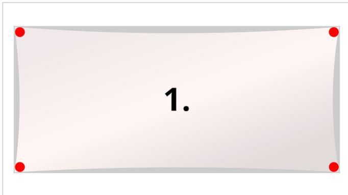
Stecken Sie zunächst alle vier Ecken nacheinander ein. So wird das Banner gleich korrekt ausgerichtet! Achten Sie darauf, die Falte an der Ecke sauber mit einzustecken.
