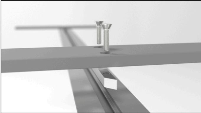
Die FüÙe werden mit Nutensteinen im unteren Profil festgeklemmt. Die Nutensteine müssen so ausgerichtet sein, dass sie sich beim Festziehen der Schrauben im Uhrzeigersinn drehen können. (Siehe Abbildung)
