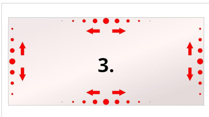
Drücken Sie Stück für Stück das Profil vollständig von der Mitte zum Rand in die Nut.
